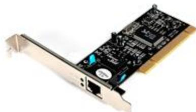
Esta Tarjeta de Red Ethernet Gigabit 10/100/1000 Mbps basada en PCI proporciona una simple conexión a una red Ethernet Gigabit, y es totalmente compatible con los estándares IEEE 802.3, 802.3u, 802.3ab y 802.3x.
